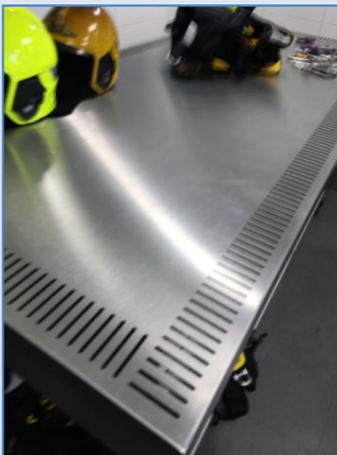
Variante 1: Absaugung Arbeitstisch
