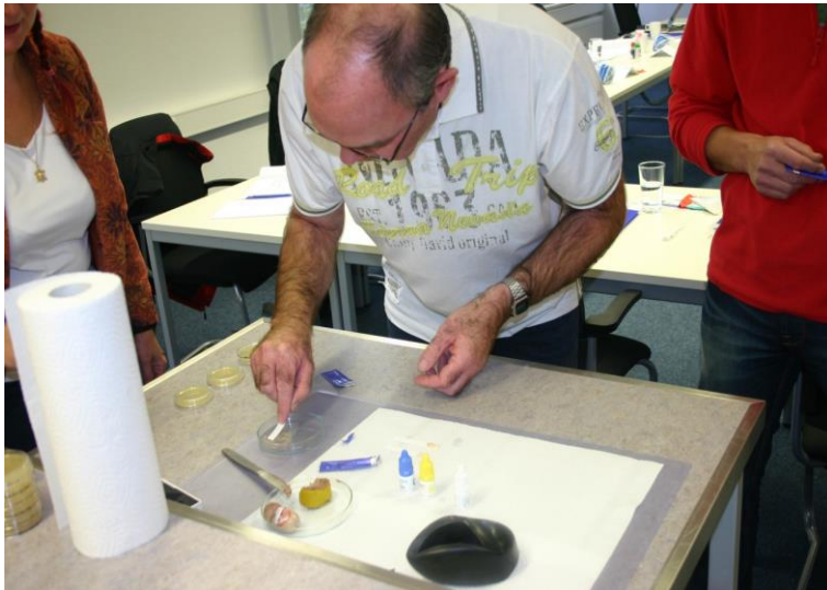
Foto 2: Kontrolle gereinigter, desinfizierter und getrockneter Teile von Vollmasken auf korrekte Desinfektion durch einen Lehrgangsteilnehmer mittels neuartigem Schnelltest
