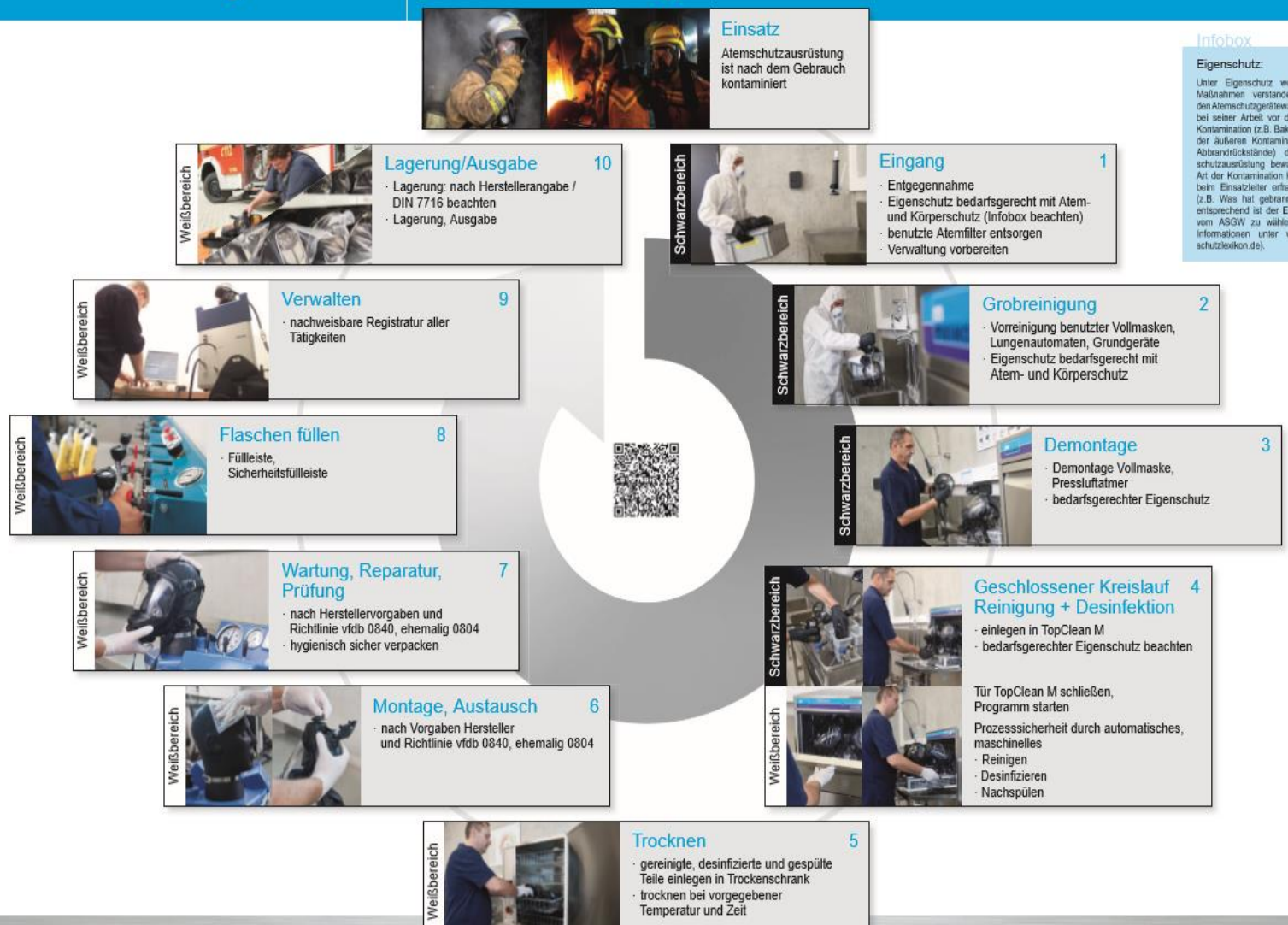
Bild 3: Kreislauf Atemschutzwerkstatt mit geschlossenem Kreislauf Reinigung und Desinfektion
