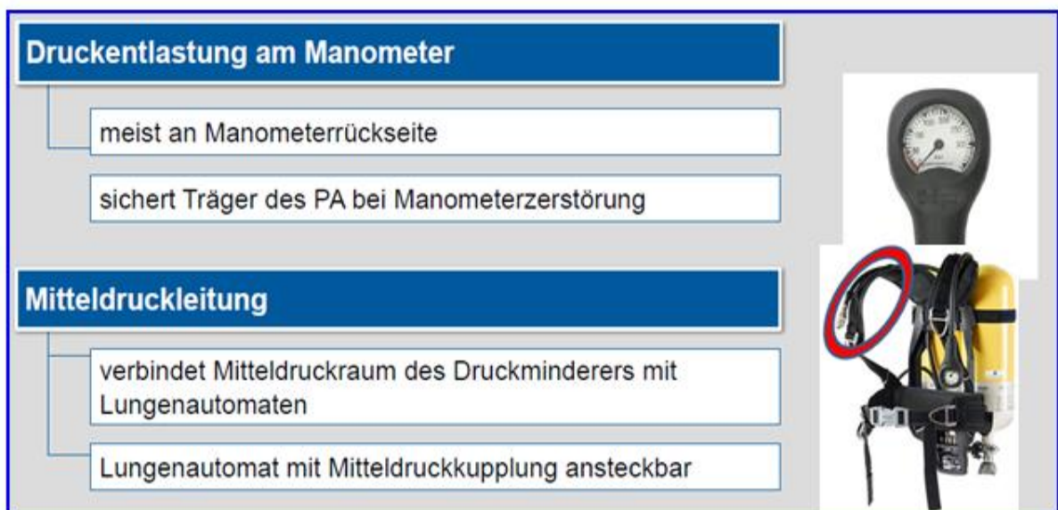
Bild 43: Druckentlastung am Manometer und Mitteldruckleitung
